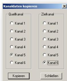
Mit der Kopierfunktion im oberen Menü (> Bearbeiten > Kanal kopieren) lassen sich die Einstellungen des Kanals 5 (Ch. 5) sehr bequem auf den Kanal 6 (Ch. 6) übertragen.
