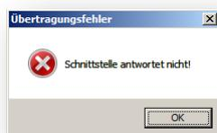
Diese Fehlermeldung mit „OK“ bestätigen und das Programm *Audaphon Cross-Control* öffnen. Sie können die richtige Schnittstelle von der Software automatisch suchen lassen.
