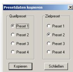
An den Kanal 1 und Kanal 2 (**Ch. 1** / **Ch. 2**) sind Hochtöner angeschlossen. In Preset 1 ist ein Filter mit der Einstellung Hoch-Pass = 24 dB pro Oktave ab 3.000 Hz eingestellt. Das Preset 1 wird auf Preset 2, Preset 3 und Preset 4 kopiert. Somit kann man sicherstellen, dass bei einem versehentlichen Umschalten von Preset 1 auf Preset 2 der Hochtöner nicht zerstört wird.
