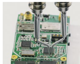
Spezielle Spitzen für 0201-Rework
