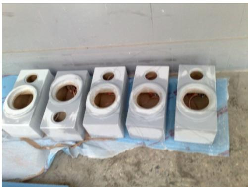
Nach dem Füllern kam wieder mal Schleifen und dann wieder das Füllern (kleine Macken nach Füllern )
