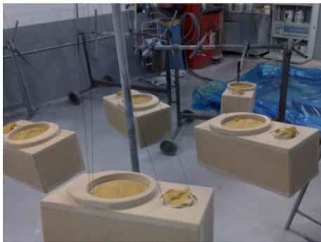
**Außen:** Nach einigen Stunden Schleifarbeiten waren die 5 dann zum Füllern bereit. An Drähten schwebend kann man von allen Seiten lackieren ohne Druckstellen zu riskieren. (hierzu die vorgebohrten Löcher für die Lautsprechermontage nutzen).
