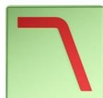
Der Subwoofer wird mit einem Tiefpassfilter von den hohen Tönen „befreit“. Auch der Tiefpassfilter arbeitet zwischen 80 Hz bis 100 Hz.
