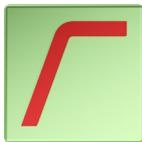
Für den Hochtöner wird ein Hochpassfilter verwendet. Wir haben in unserem Beispiel 2.100 Hz als Übernahmefrequenz eingestellt. Der Kalottenhochtöner wird mit einem Filter 2. Ordnung (12 dB / Oktave) angekoppelt.
