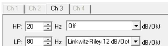
Riley 12 dB/Oct). Die Subwoofer sollen auch identisch gefiltert werden. Also Kanal 3 (Ch 3) für den linken Subwoofer soll identisch sein mit Kanal 4 (Ch 4) für den rechten Subwoofer. Dazu geht man erneut auf den Menüpunkt > *Bearbeiten*, wählt > *Kanal kopieren*, klickt in der Maske links bei Quellkanal auf die 3 und rechts bei Zielkanal auf die 4, dann klickt man auf die Schaltfläche „Kopieren“ und anschließend auf die Schaltfläche „Schließen“.
