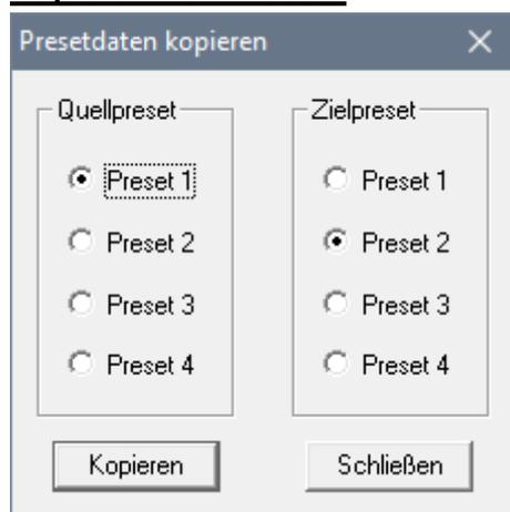
Presets sind Klang- und Frequenzweicheneinstellungen die mit einem Taster auf der Front vom AMP-2200 gewechselt werden können. Die Presets (E) kann man ohne PC im laufenden Betrieb wechseln. Vier LEDs zeigen das aktuell eingestellte Preset. Die Presets kann man mit der Kopierfunktion bearbeiten. Unter dem Menüpunkt „Bearbeiten“ finden Sie den Eintrag „Preset kopieren...“. Es erscheint ein Fenster mit dem Quellpreset und dem Zielpreset. In unserem Beispiel ist das
