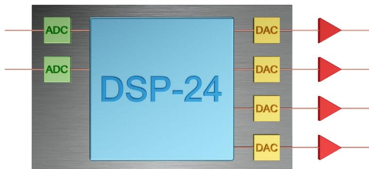
Die linke Abbildung zeigt den schematischen Aufbau vom *audaphon AMP-2200*. Im Eingangsbereich wandeln die Analog-Digital-Konverter (**grün**) das analoge Signal in ein digitales
