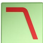
Der DON wird bei 60 Hz angekoppelt und bekommt noch eine Tiefbassanhebung bei 25 Hz. Man braucht einen separaten Verstärker für die Subwoofer!
