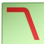
Die Subwoofer werde mit dem Tiefpassfilter von den hohen Tönen „befreit“ und durch die Einstellung der Trennfrequenz und die Steilheit der Filter kann man die Subwoofer homogen an die Satelliten ankoppeln.
