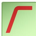
Die Satelliten werden mit einem Hochpassfilter von tiefen Tönen befreit. Kleine Satelliten kann man bei 100 Hz trennen. Dann sollten aber die Subwoofer in der Nähe stehen. Erst ab 80 Hz kann man den Subwoofer nicht mehr orten. Also wenn es die Größe der Satelliten erlaubt, sollte man unter 100 Hz trennen.
