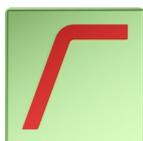
Für den Hochtöner wird ein Hochpassfilter verwendet. In diesem Beispiel wird 2.100 Hz als Übernahmefrequenz eingestellt. Der Kalottenhochtöner wird mit einem Filter 3. Ordnung (18 dB / Oktave) angekoppelt.
