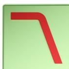
Der Mittel-Tieftöner wird mit einem Tiefpassfilter 2. Ordnung (12 dB / Oktave) beschaltet. Dieser arbeitet mit einer Trennfrequenz von 1.500 Hz.
