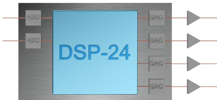
Ein DSP ist ein Mikrocomputer, dessen interne Architektur für die schnellstmögliche Verarbeitung von digitalen Signalen optimiert ist. Der DSP bekommt vom ADC die digitalisierten Audiosignale. Diese Signale können mit spezifischen Filtern versehen werden. Die Eingänge können den Ausgängen individuell zugewiesen werden, diesen Vorgang nennt man Routing.
