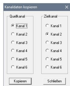
In diesem Beispiel werden die Kanäle für die Satelliten kopiert. Also Kanal 2 (Ch 2) für den rechten Satelliten wird identisch beschaltet wie Kanal 1 (Ch 1) für den linken Satelliten. Dazu geht man auf den oberen Menüpunkt > *Bearbeiten*, wählt den Eintrag > *Kanal kopieren*, klickt in der Maske links bei Quellka-
