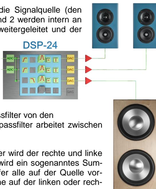
Mit dem Delay, den Equalizern und der Lautstärkeanpassung werden die Komponenten aufeinander und den Raum angepasst.
