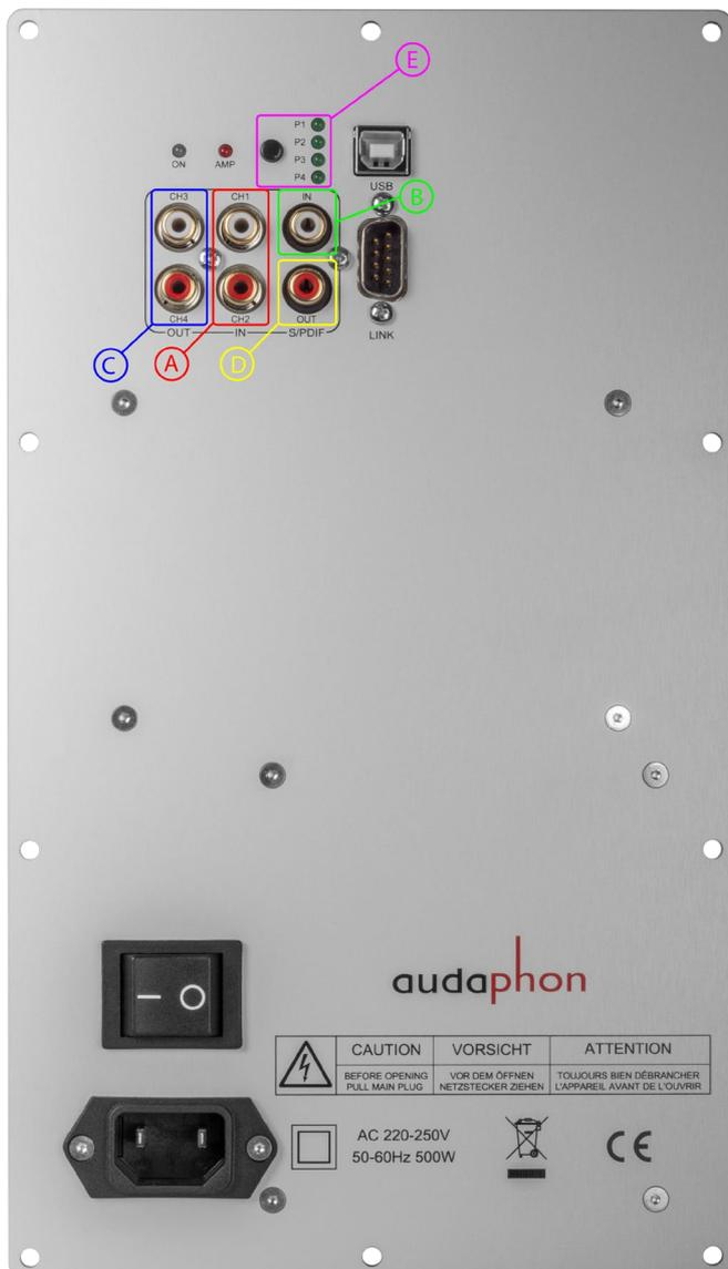
Kanal 3 und 4 sind für externe Geräte als analoge Ausgänge **(C)** herausgeführt.
