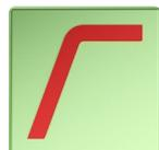
Die Satelliten werden mit einem Hochpassfilter von tiefen Tönen entlastet. Es werden meist 12 dB Filter bei 80 Hz bis 100 Hz verwendet.
