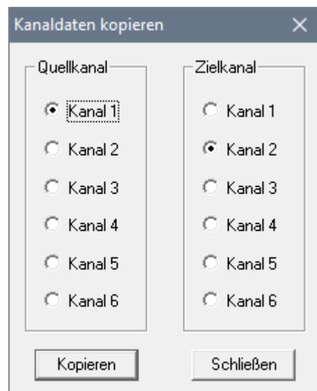
Die Kanäle können mit einer Kopierfunktion bearbeitet werden. Dazu geht man auf den Menüpunkt > Bearbeiten, wählt den Eintrag > Kanal kopieren, klickt in der Maske beim Quellkanal auf die gewünschte Vorlage und rechts bei Zielkanal den zu ersetzenden Kanal an. Anschließend klickt man auf die Schaltfläche „Kopieren“ und auf die Schaltfläche „Schließen“.
