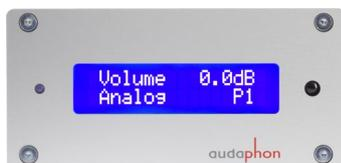
Der *audaphon AMP-2200* kann mit einem zusätzlichen Display und einer Fernbedienung erweitert werden (nicht im Lieferumfang enthalten). Dazu wird eine Steuereinheit mit Display an die entsprechende Schnittstelle angeschlossen. Die optionale Steuereinheit wird mit einem Flachbandkabel angesteckt und ist sofort einsatzbereit. Mit dieser Konfiguration kann man die Presets auswählen und die Lautstärke regeln.
