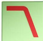
Der Tieftöner ist mit einem Tiefpassfilter 2. Ordnung (12 dB / Oktave) beschaltet. Die Kanäle 1 und 2 werden für den Subwoofer verwendet und der Brückenbetrieb wird aktiviert (siehe: Subwoofer im Brückenbetrieb).
