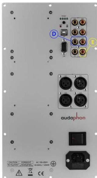
Bei separatem Vor- und Endverstärker werden die Eingänge vom audaphon AMP-4250 an die Ausgänge vom Vorverstärker angeschlossen. Die Ausgänge (D) vom audaphon AMP-4250 werden an die Eingänge des Endverstärkers angeschlossen.
