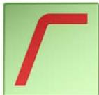
Für den Hochtöner wird ein Hochpassfilter verwendet. Wir haben in unserem Beispiel 2.100 Hz als Übernahmefrequenz eingestellt. Der Kalottenhochtöner wird mit einem Filter 2. Ordnung (12 dB / Oktave) angekoppelt.
