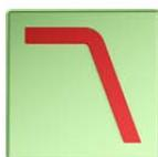
Die Subwoofer werde mit dem Tiefpassfilter von den hohen Tönen befreit und über Trennfrequenz und Steilheit der Filter an die Satelliten angekoppelt.
