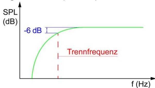
Der HP-Filter lässt hohe Frequenzen oberhalb der eingestellten Trennfrequenz „passieren“.
