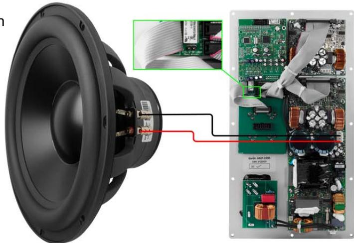
Im Brückenbetrieb muss man zusätzlich den mitgelieferte Jumper<sup>4</sup> auf die zwei Pins („Ch1 / Ch2 - Bridge Operation“) stecken.
