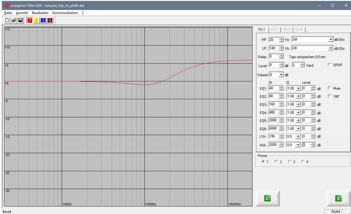
In dem Beispiel oben kann man einen High-Shelf Filter sehen mit der Einsatzfrequenz 2.000 Hz, einer Güte von 0,5 und einer Anhebung von +6 dB. In der Abbildung unten ist der gleiche Filter aber mit einer Absenkung von -12 dB zu sehen.
