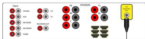
Wenn ein Mehrkanalverstärker die Quelle ist, wird der Eingang vom *AMP-4250* mit dem Subwooferausgang vom Mehrkanalverstärker (AV-Receiver) verbunden.
