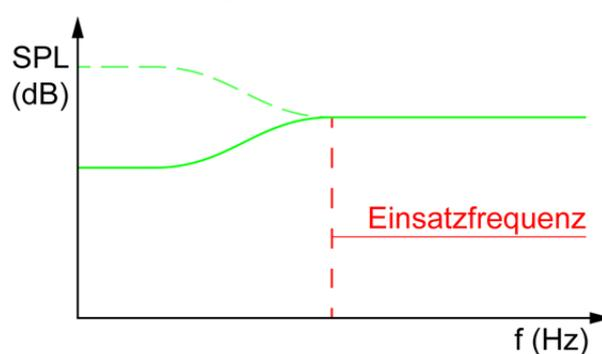
Der Low-Shelf Filter lässt alle Frequenzen „passieren“ und hebt ab der eingestellten Einsatzfrequenz das Frequenzband zu den tiefen Frequenzen hin an bzw. senkt das Frequenzband ab.
