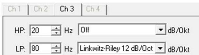
Also Kanal 3 (Ch 3) für den linken Subwoofer soll identisch sein mit Kanal 4 (Ch 4) für den rechten Subwoofer. Dazu geht man erneut auf den Menüpunkt > *Bearbeiten*, wählt > *Kanal kopieren*, klickt in der Maske links bei Quellkanal auf die 3 und rechts bei Zielkanal auf die 4, dann klickt man auf die Schaltfläche „Kopieren“ und anschließend auf die Schaltfläche „Schließen“.
