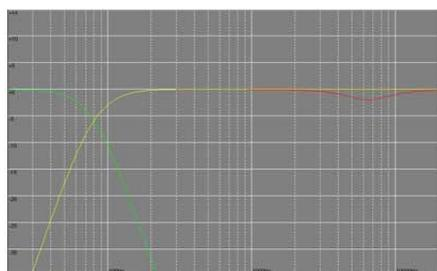
In diesem Beispiel ist ein Satellitenpaar über den DSP geschleift und es wird durch den DSP unterhalb von 80 Hz abgetrennt; außerdem wird eine Übertreibung des Lautsprechers bei 6.500 Hz abgemildert.
