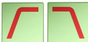
Der Tieftöner bekommt einen Bandpassfilter 2. Ordnung (12 dB / Oktave). Die Übernahmefrequenzen liegen bei 200 Hz und 60 Hz. Man braucht einen separaten Verstärker für die Woofer!
