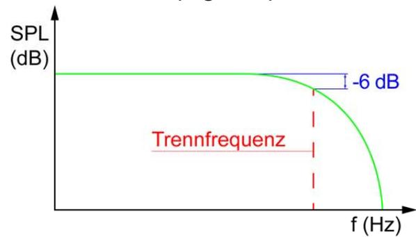
Der LP-Filter lässt tiefe Frequenzen unterhalb der eingestellten Trennfrequenz „passieren“.
