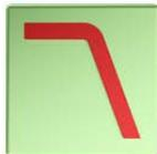
Der Mittel-Tieftöner wird mit einem Tiefpassfilter beschaltet. Dieser Filter 2. Ordnung (12 dB / Oktave) arbeitet mit einer Trennfrequenz von 1.500 Hz.
