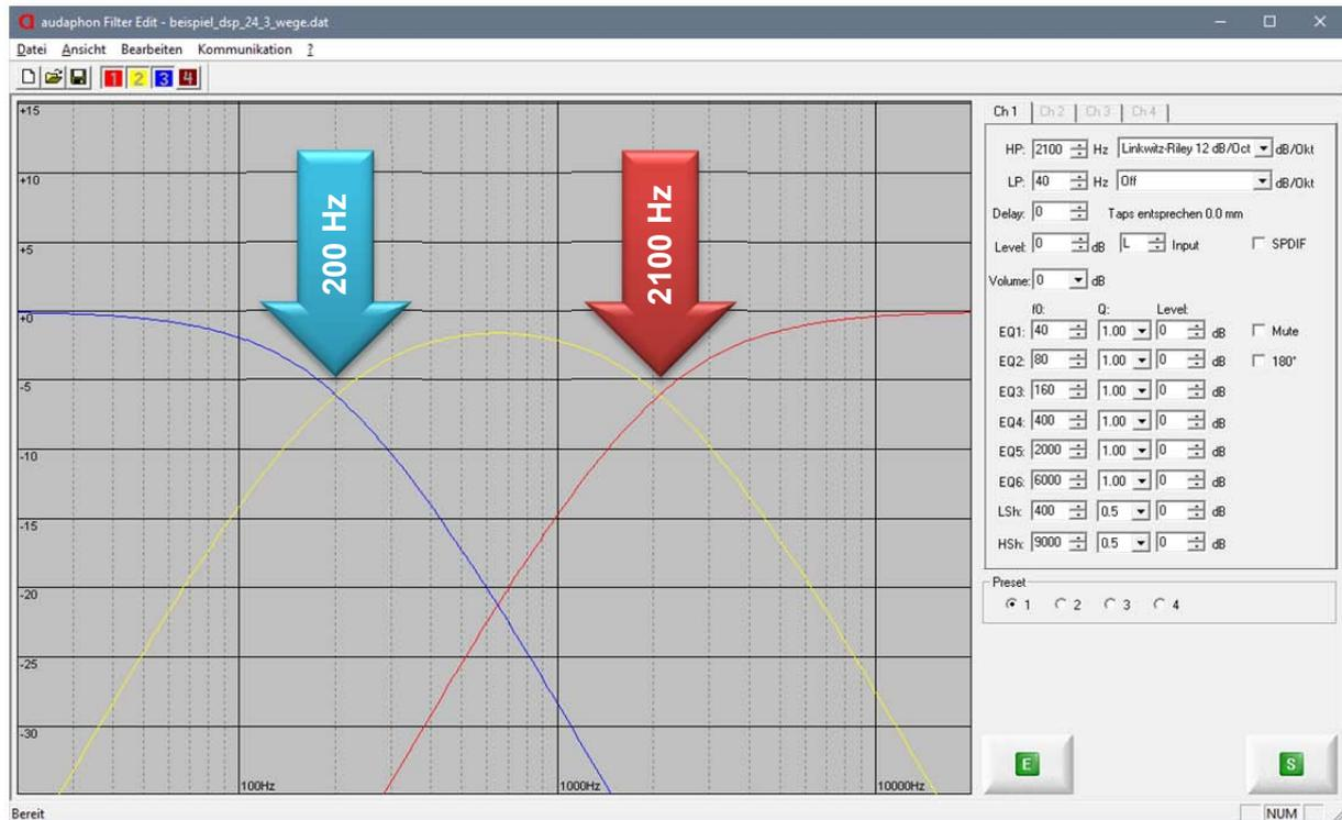
Kanal 3 (Ch 3) wird für den Bass eingestellt. Der Lowpass-Filter wird mit 200 Hz und Linkwitz-Riley Charakteristik mit einer Flankensteilheit von 12 dB eingerichtet.
