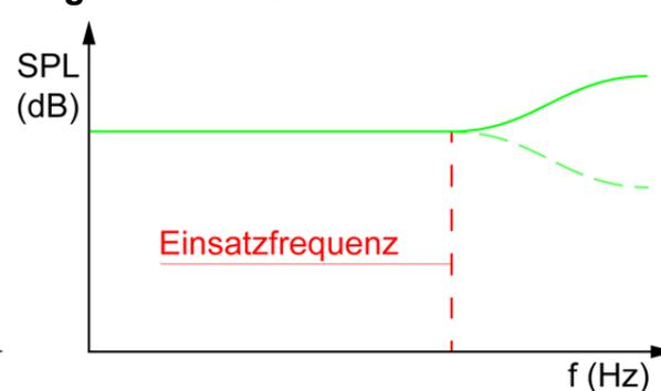
Der High-Shelf Filter lässt alle Frequenzen „passieren“ und hebt ab der eingestellten Einsatzfrequenz das Frequenzband zu den hohen Frequenzen hin an bzw. senkt das Frequenzband ab.
