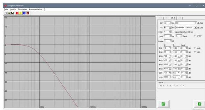
In der linken Abbildung kann man den Tiefpassfilter bei 80 Hz in der Filter-Edit-Software sehen. Der LP (Lowpassfilter) arbeitet mit 12 dB / Oktave Flankensteilheit.
