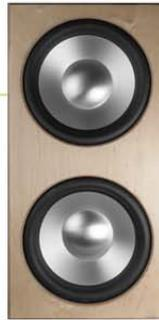
Bei Verwendung von einem Subwoofer wird der rechte und linke Kanal addiert und auf den Ausgang 1 und 2 gelegt. Es wird ein sogenanntes Summsignal gebildet. Somit bekommt der Subwoofer alle vorhandenen Tieftonsignale. Die linke Abbildung zeigt den Subwoofer [DON](#) mit
