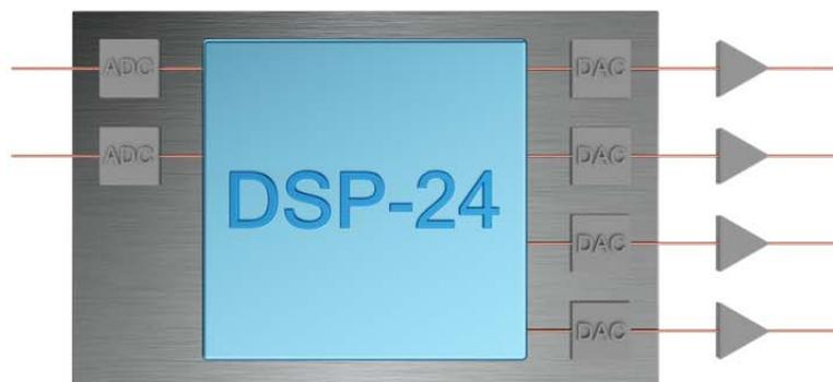
Ein DSP ist ein Mikrocomputer, dessen interne Architektur für die schnellstmögliche Verarbeitung von digitalen Signalen optimiert ist. Der DSP bekommt vom ADC die digitalisierten Audiosignale. Diese Signale können mit spezifischen Filtern versehen werden. Die Eingänge können den Ausgängen individuell zugewiesen werden, diesen Vorgang nennt man
