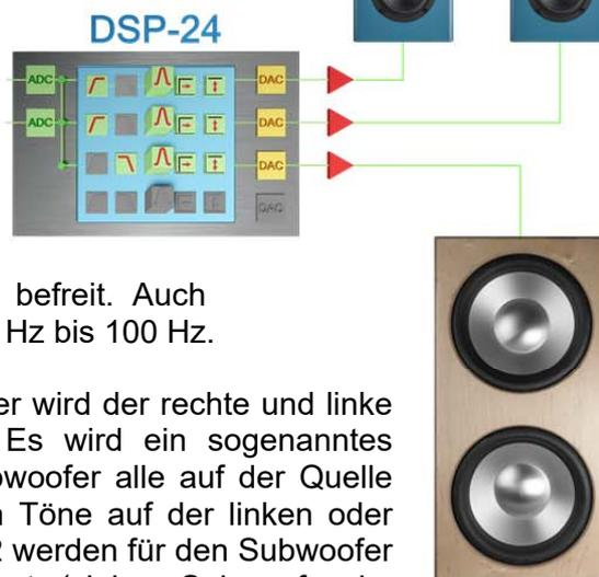
Mit dem Delay, den Equalizern und der Lautstärkeanpassung werden die Komponenten aufeinander und den Raum angepasst.
