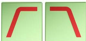
Die Mitteltöner werden mit einem Hochpass- und einem Tiefpassfilter beschaltet. Diese Kombination aus zwei Filtern wird auch Bandpassfilter genannt. Dieser Filter 2. Ordnung (12 dB / Oktave) arbeitet zwischen 200 Hz und 2.100 Hz.
