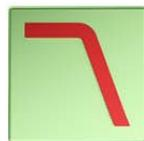
Der Subwoofer wird mit einem Tiefpassfilter von den hohen Tönen befreit. Auch der Tiefpassfilter arbeitet zwischen 80 Hz bis 100 Hz.
