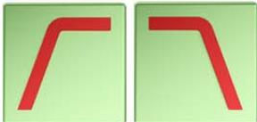
Der Mitteltöner wird mit einem Hochpass- und einem Tiefpassfilter beschaltet. Diese Kombination aus zwei Filtern wird auch Bandpassfilter genannt. Dieser Filter 2. Ordnung (12 dB / Oktave) arbeitet zwischen 200 Hz und 2.100 Hz.
