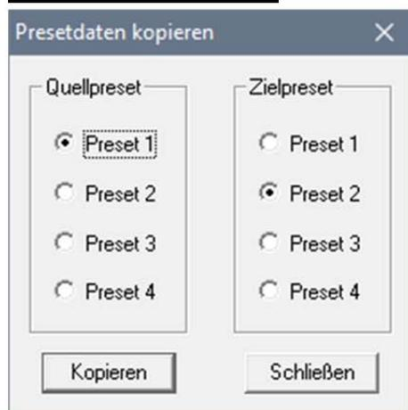
Presets sind Klang- und Frequenzweicheneinstellungen die mit einem Taster **(F)** auf der Rückseite vom AMP-4250 gewechselt werden können. Die Presets kann man ohne PC im laufenden Betrieb wechseln. Vier LEDs zeigen das aktuell eingestellte Preset. Die Presets kann man mit der Kopierfunktion bearbeiten. Unter dem Menüpunkt „Bearbeiten“ finden Sie den Eintrag „Preset kopieren...“. Es erscheint ein Fenster mit dem Quellpreset und dem Zielpreset. In unserem
