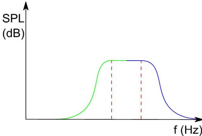
Eine Sonderform der Filter ist der Bandpass Filter. Der Bandpass Filter (auch Bandbreitenfilter) ist eine Kombination aus High-Pass und Low-Pass Filter. Ein typisches Anwendungsbeispiel ist der Mitteltöner in einem 3-Wege-System. Die Einstellungen für den *audaphon AMP-4250* sind schon im Beispiel 3 erläutert.
