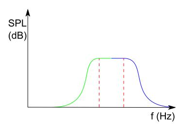
Eine Sonderform der Filter ist der Bandpass Filter. Der Bandpass Filter (auch Bandbreitenfilter) ist eine Kombination aus High-Pass und Low-Pass Filter. Ein typisches Anwendungsbeispiel ist der Mitteltöner in einem 3-Wege-System. Die Einstellungen für den audaphon DSP-24 sind schon im Beispiel 3 erläutert.
