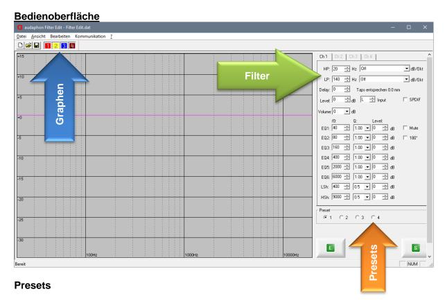
Hier kann man vier verschiedene Konfigurationen unter den Menüpunkten "Preset 1 bis Preset 4" speichern und im laufenden Betrieb des DSP per Fernbedienung ohne angeschlossenen PC wechseln. Das ist praktisch, um unterschiedliche Klangeinstellungen und Frequenzübergänge schnell abrufen zu können.
