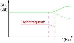
Der High-Shelf Filter lässt alle Frequenzen "passieren" und hebt ab der eingestellten Frequenz das Frequenzband zu den hohen Frequenzen hin an bzw. senkt das Frequenzband ab.
