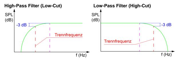
Der HP-Filter lässt hohe Frequenzen oberhalb der eingestellten Trennfrequenz "passieren".
