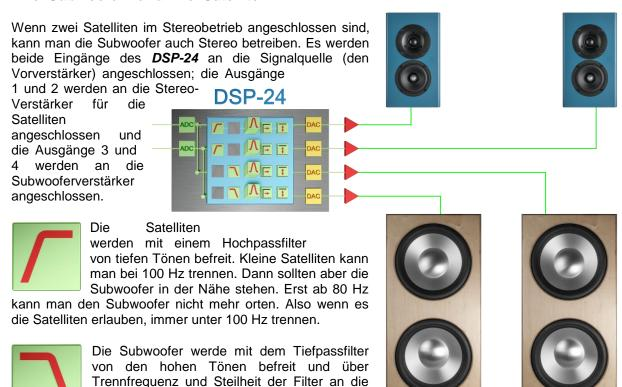
Mit dem Delay, den Equalizern und der Lautstärkeanpassung werden die Komponenten aufeinander und den Raum angepasst. Der **audaphon DSP-24** kann die Gesamtlautstärke über die Fernbedienung regeln.
