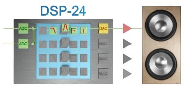
Verwendung Bei von einem Subwoofer wird der rechte und linke Kanal addiert und auf einen Ausgang gelegt. Es wird ein sogenanntes Summensignal gebildet. Somit bekommt Subwoofer, in unserem Beispiel der DON, alle vorhandenen Tieftonsignale, egal ob diese Töne auf der linken oder rechten Spur
