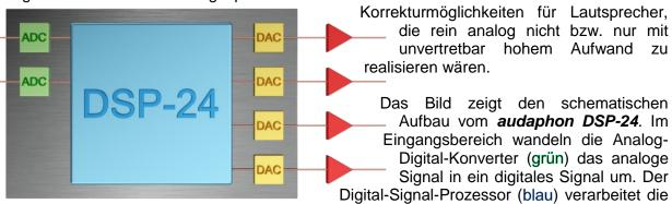
Daten nach den eingestellten Konfigurationen. Diese Konfigurationen können aus Pegelanpassungen, Frequenzübergängen und parametrischen Equalizer-Einstellungen bestehen und beliebig kombiniert werden. Der Digital-Analog-Konverter (gelb) wandelt die bearbeiteten digitalen Signale aus dem DSP in analoge Signale und diese Signale werden anschließend an die externen Verstärker (rot) weitergeleitet.
