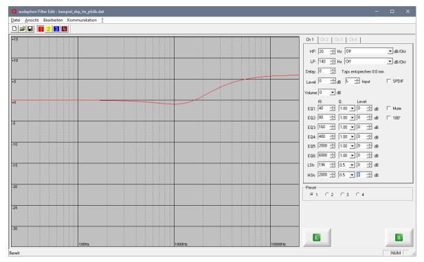
In dem Beispiel oben kann man einen High-Shelf Filter sehen mit der Frequenz 2000 Hz, einer Güte von 0,5 und einer Anhebung von +6 dB. Im Bild unten ist der gleiche Filter aber mit einer Absenkung von -12 dB zu sehen.
