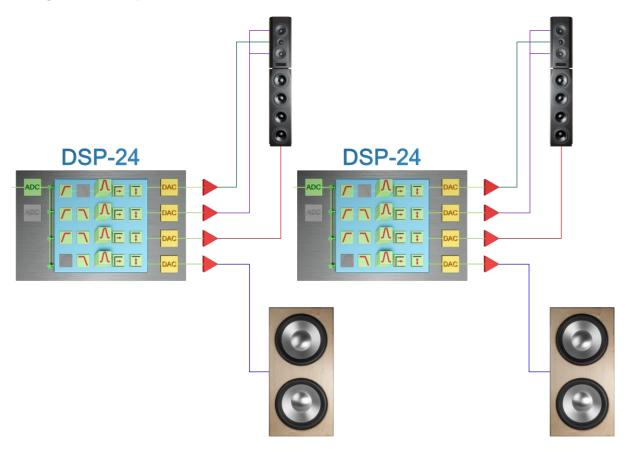
Ein **audaphon DSP-24** wird an den rechten Kanal und der zweite **DSP-24** wird an den linken Kanal von der Signalquelle (Vorverstärker) angeschlossen. Bei unserem Beispiel haben wir die Raquel + Marco Lautsprecher mit dem DON Subwoofer aktiviert.
