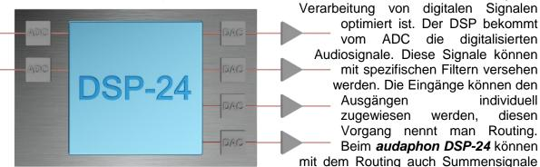
gebildet werden, d. h. der rechte und linke Kanal werden addiert und auf einen Ausgang gelegt. Diese Addition von Signalen braucht man z. B. für Subwoofer. Jedem der vier Kanäle kann man parametrische Equalizer zuordnen. Das Einstellen einer Zeitkorrektur ist auch für jeden einzelnen Kanal möglich. Im DSP wird auch die Lautstärke geregelt. Somit kann man das Gerät auch als Volumenkontrolle verwenden. Die Signalverarbeitung im *audaphon DSP-24* erfolgt mit 48 Bit.
