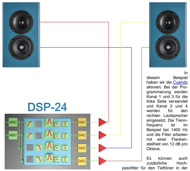
Cuando gesetzt werden. Das erhöht die maximale Lautstärke der Cuando. Der 12 cm Tieftöner muss für tiefe Töne eine hohe Membranauslenkung realisieren. Wenn man den
