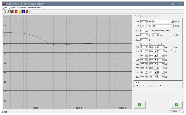
In dem Beispiel oben kann man einen Low-Shelf Filter sehen mit der Frequenz 200 Hz, einer Güte von 0,5 und einer Anhebung von +4 dB. Im Bild unten ist der gleiche Filter aber mit einer Absenkung von -12 dB zu sehen.
