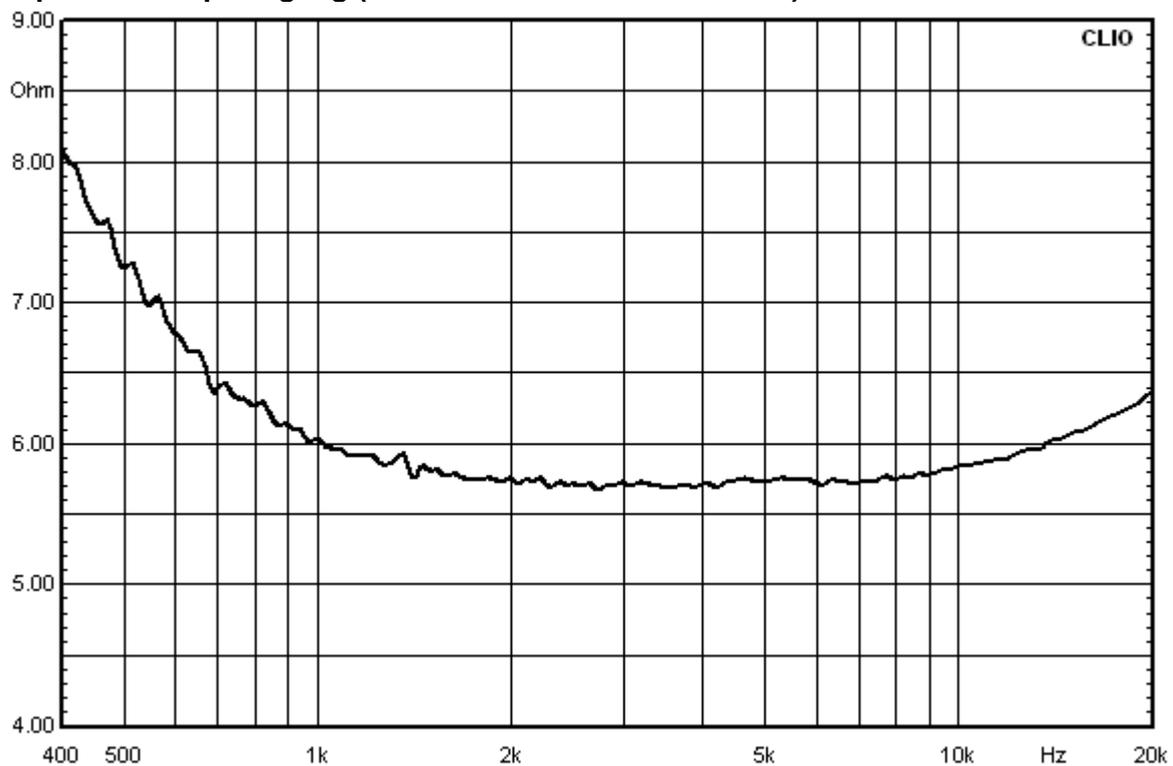
Abbildung 4: Audiopur MAG17P -Impedanzverlauf
