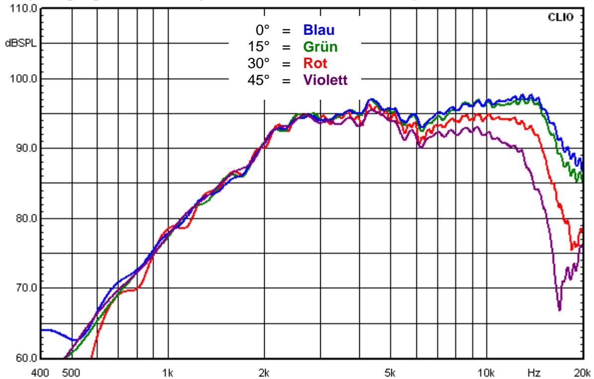
Abbildung 3: Audiopur MAG17P -Frequenzgänge unter verschiedenen Winkeln
