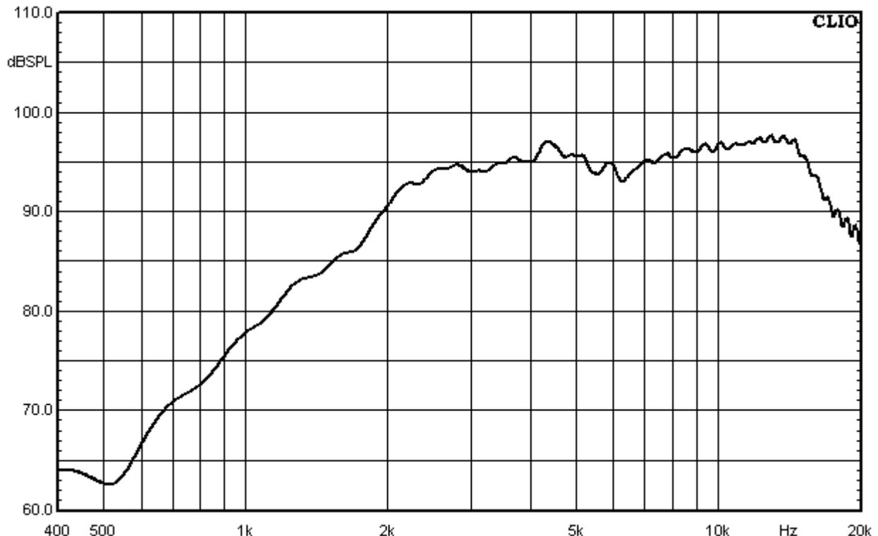
Abbildung 2: Audiopur MAG17P -Frequenzgang auf Achse
