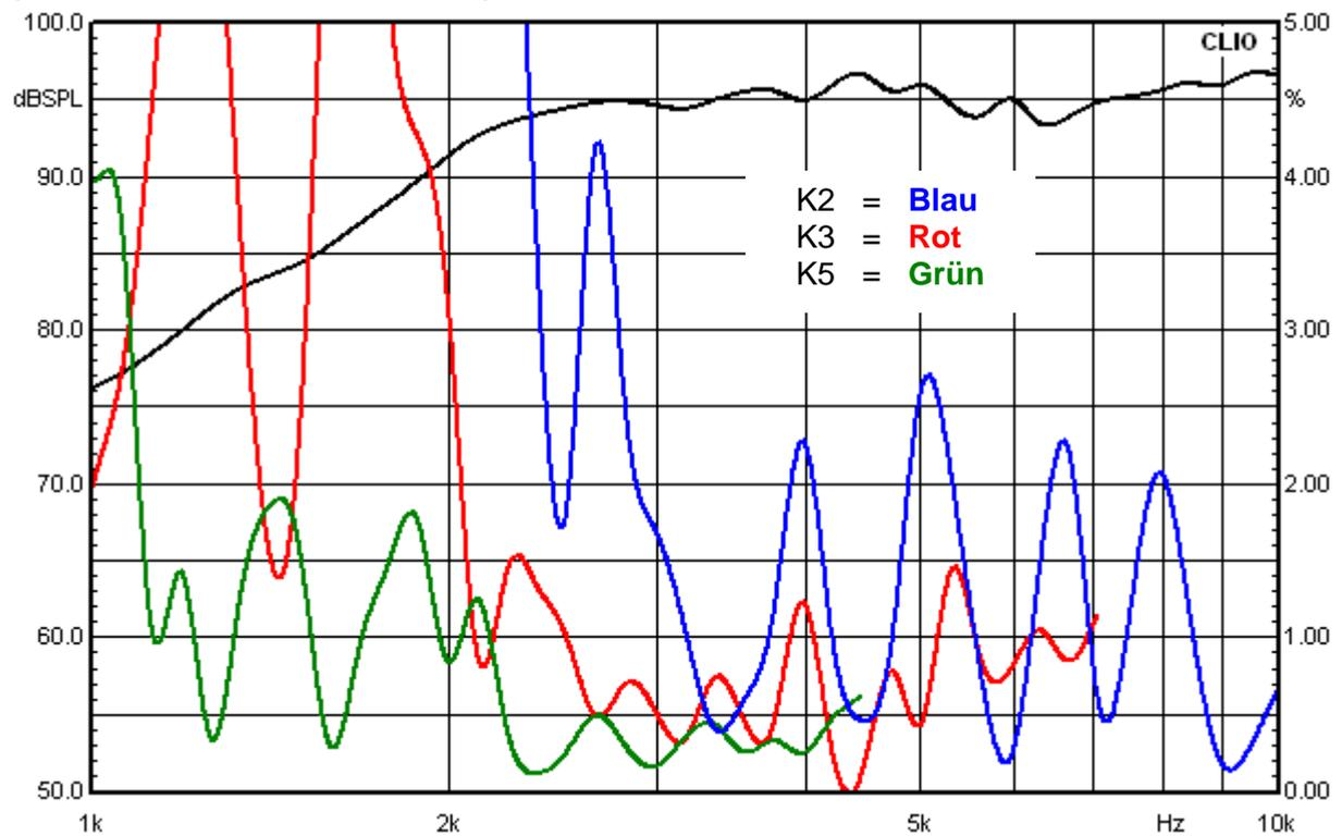
Abbildung 2: Audiopur MAG17P -Klirrmessung bei 95 dB
