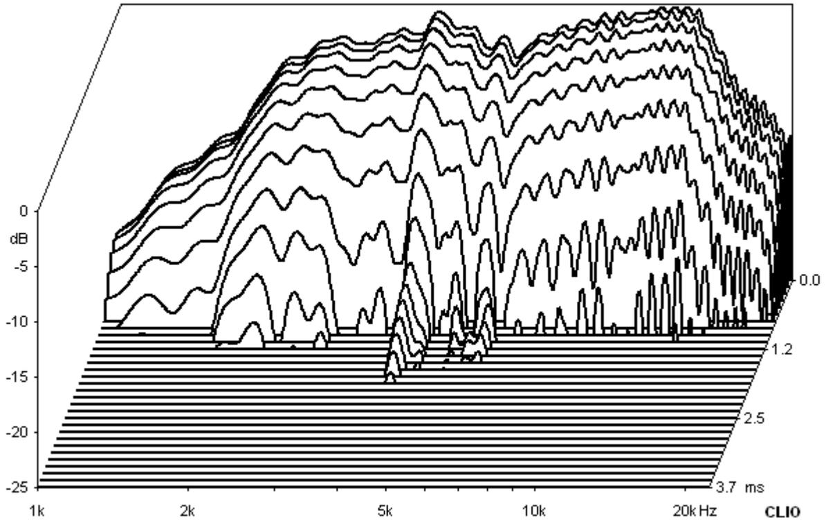
Abbildung 5: Audiopur MAG17P -Wasserfallspektrum auf Achse (0°)
