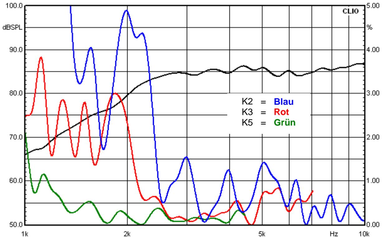
Abbildung 6: Audiopur MAG17P -Klirrmessung bei 85 dB
