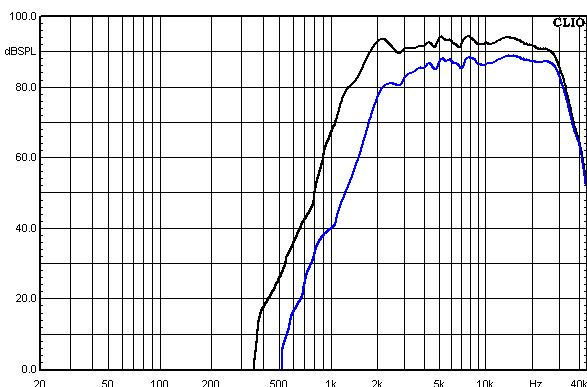
In der Abbildung ist der Frequenzgang vom Audaphon AMT-2i unbeschaltet (schwarz) und mit Frequenzweiche (blau) zu sehen. Der Filter 3. Ordnung wird mit 3 Bauteilen realisiert. Dabei sind die beiden in Reihe geschalteten Kondensatoren ( $3,9 \mu\text{F}$  und  $10 \mu\text{F}$ ) mit niedrigen Toleranzen und hoher Klangqualität zu wählen.
